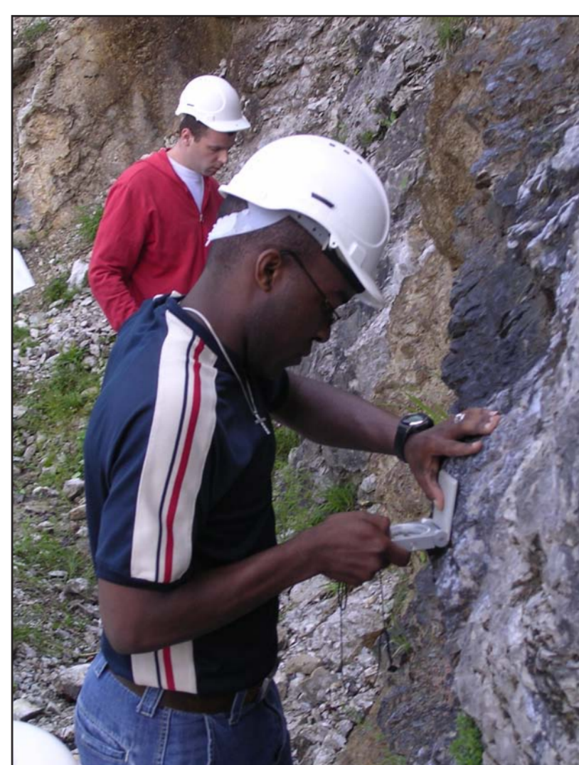
Abb. 1: Klassische Aufnahme einer Felsböschung mit Gefügekompaß
