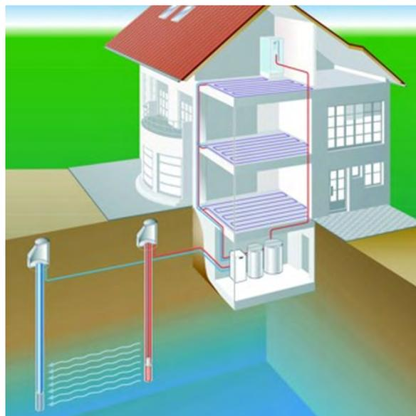
Abb. 19: Grundwasserwärmepumpensystem [WEI13]
