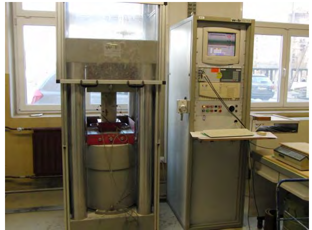
Abbildung 1-3 E-Modulbestimmung für Estrich, MFPA Leipzig
