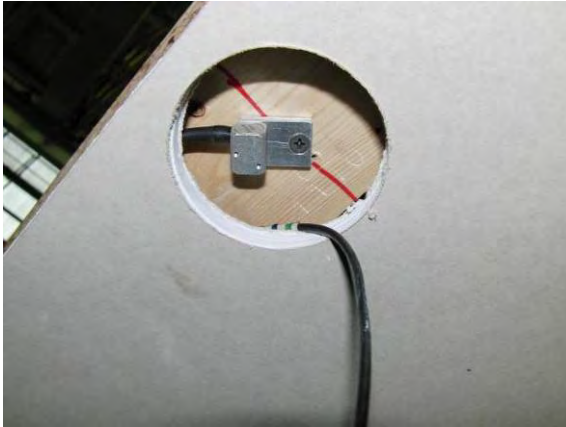
Abbildung 6-2 Beschleunigungsaufnehmer auf Holz befestigt in Aussparung von Unterhangdecke
