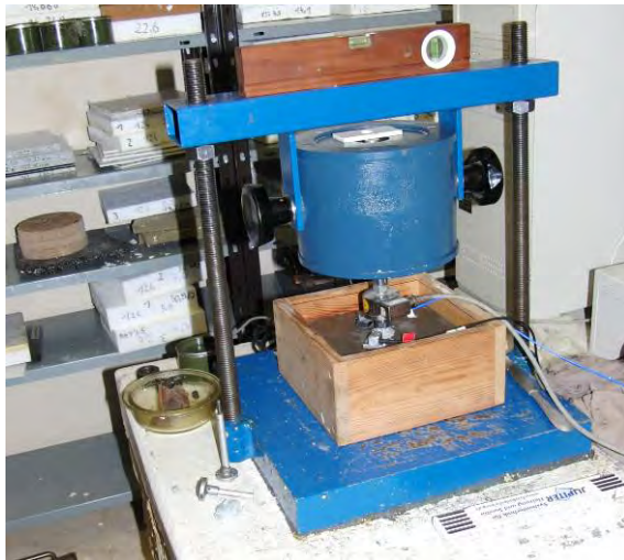
Abbildung 6-40 Versuchsstand zur Ermittlung der Materialdämpfung mit Shaker, am Beispiel Split
