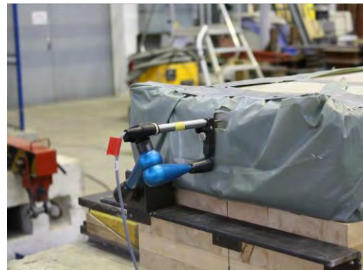
Abbildung 6-33 Wegaufnehmer misst Relativverschiebung zwischen Estrichplatte und Holz
