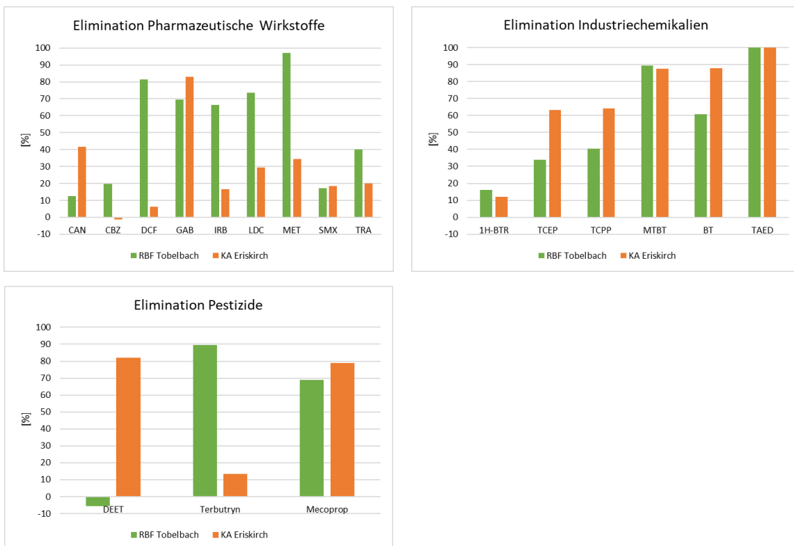
Abbildung 5.22: Vergleich Spurenstoffentnahme Kläranlage Eriskirch und RBF Tobelbach
