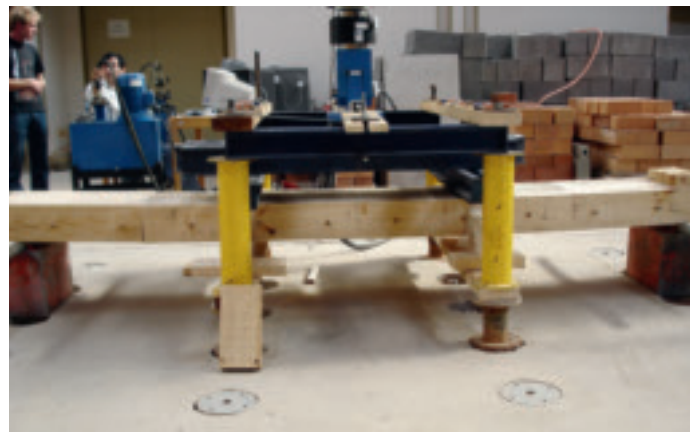
Druck- und Biegefestigkeit von Leimbindern werden am IfH geprüft.
