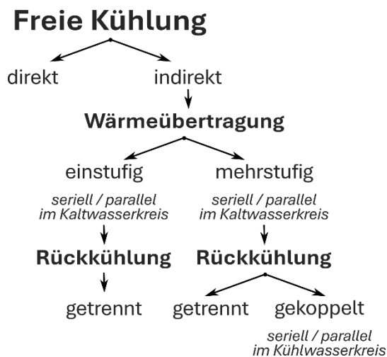
Abbildung 4-1: Unterscheidungsmerkmale von Freikühlsystemen
